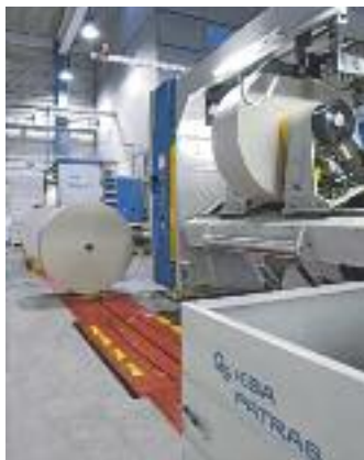
Automatische Rollenbeschickung und Restrollen-Entsorgung mit KBA Patras.
