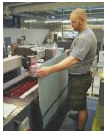
Druckteam-Mitarbeiter Dustin Richter beim Plattenladen an einer der Bogenoffsetdruckmaschinen.
