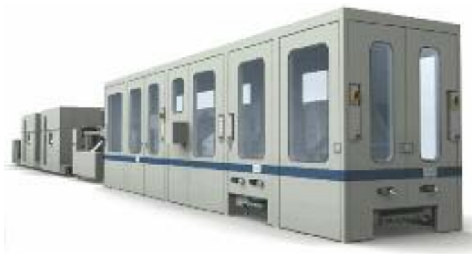
Digitale Weiterverarbeitung mit FoldLine: Durch ein solches Falzwerk von manroland web systems rauschen täglich die Exemplare des »Walliser Boten« im schweizerischen Visp.
