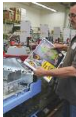
Der neue Falzanleger 0507 kann von Hand (im Bild Zofinger-Tagblatt-Maschinenführer Vajo Krstic) oder mittels Streamfeeder beschickt werden.
